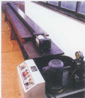
Máquina para comprobar la fatiga de los rodamientos de los escalones principal y auxiliares
